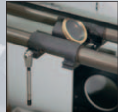
Gravieroptik mit Fokustaster und Fokuslinse
